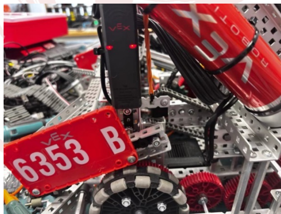
图 10: 可变角吸子的链条结构
